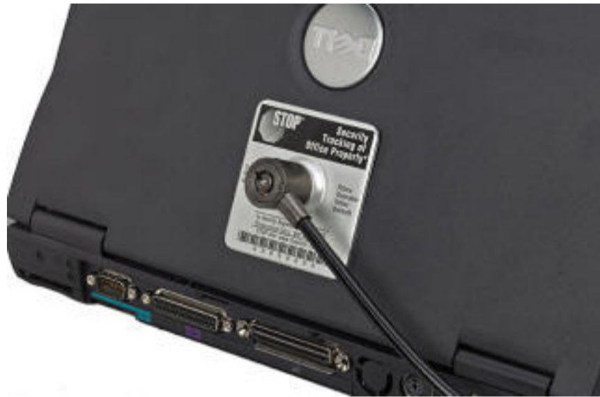
Ilustración 50 · Protección física II
